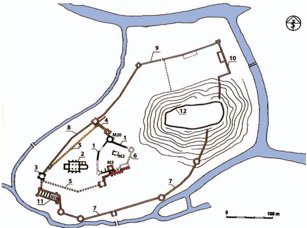
5 pav. Vilniaus pilių statinių XIII a. antroje pusėje – XIV a. pirmojoje pusėje planas pagal N. Kitkauską: I etapas pažymėtas juodai; II etapas – raudonai; III etapas – rausvai. 1 – mažojo gynybinio aptvaro sienos; 2 – katedra; 3 – kvadrato formos bokštas; 4–6 – mažojo gynybinio aptvaro sienos; 7–10 – didžiojo gynybinio aptvaro sienos; 11 – Vyskupo namas; 12 – aukštutinės pilies medžio ir žemės gynybinis aptvaras.
